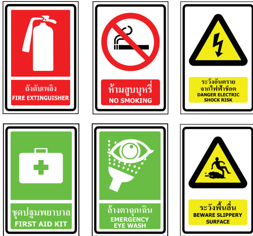
ภาพที่ 5.2 ตัวอย่างสัญลักษณ์ที่ติดตั้งไว้กับอุปกรณ์ ความปลอดภัย หรือป้ายห้ามในพื้นที่ทำงาน ที่มา: www.neosafetysign.com
