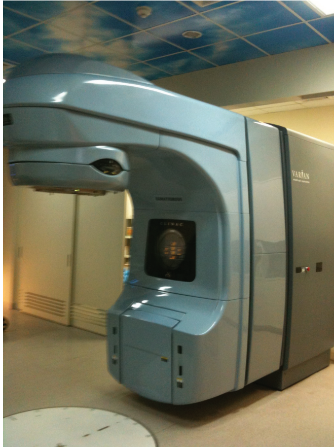
ภาพที่ 7.4 เครื่องฉายรังสีรักษาชชนิดเร่งอนุภาคอิเล็กตรอน (Linear accelerator) แผนกรังสีรักษาและมะเร็งวิทยา โรงพยาบาลรามธิบดี
